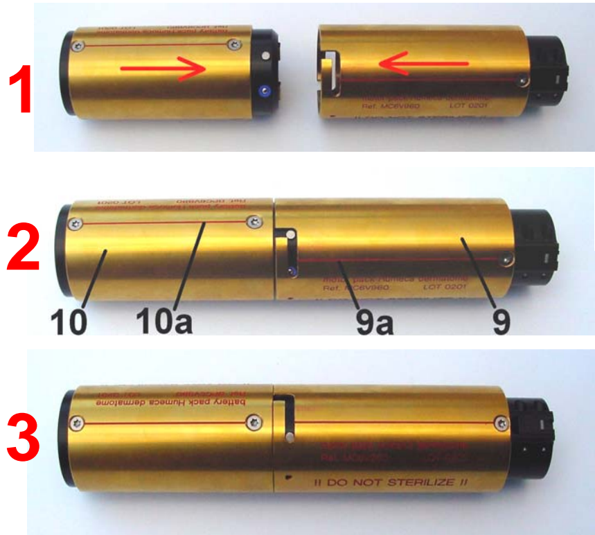
Fig. 4. Junção dos cartuchos do Motor e da Bateria
