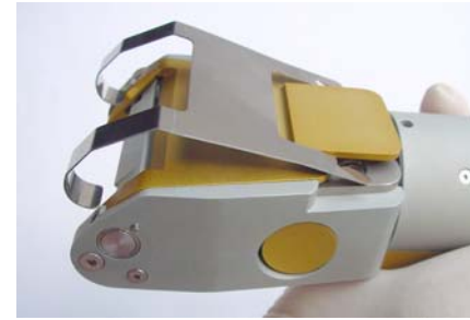
Fig.21. Colocando a guia de redução de largura (2)
