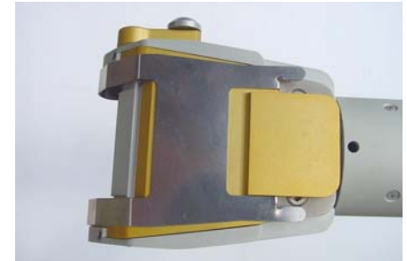
Fig.21. Colocando a guia de redução de largura (2)
