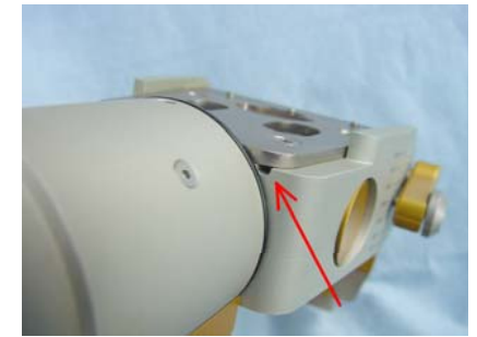
Fig. 23. Removendo a tampa da placa
