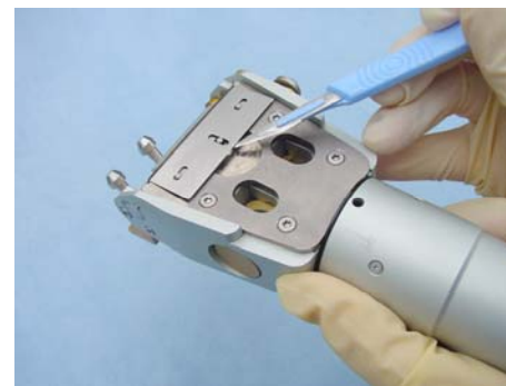
Fig.15. Forma correta para remover a lâmina
